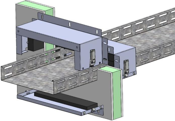
Le boîtier peut être facilement installé sur des câbles existants : il est composé de deux parties qui viennent se fixer autour de câbles/cheminements déjà en place.
