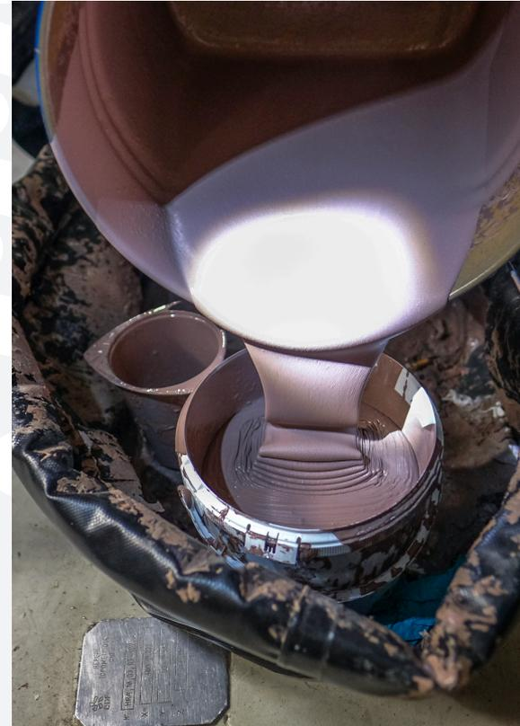
NuJOINT 3130 est un élastomère silicone radiologique souple utilisé comme barrière radiologique, coupe-feu et étanche dans le calfeutrement de traversées et fourreaux, principalement dans les centrales nucléaires ou autres sites nucléaires
