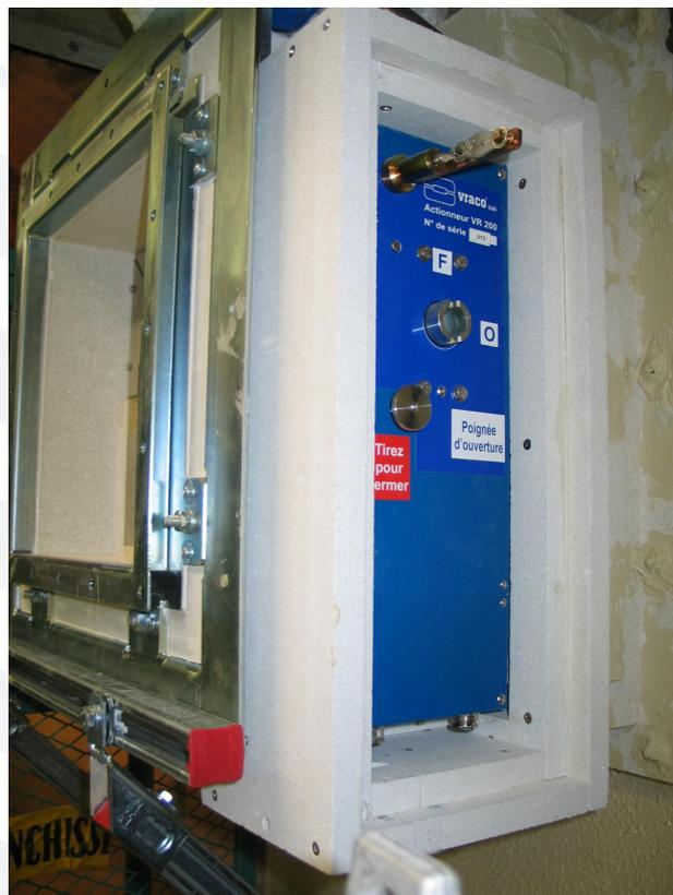
Clapet à portée sèche inclinée et inversée, manœuvrable à chaud. La famille des clapets coupe-feu NuFDA-2XX sont particulièrement performants en termes d'opérabilité et manœuvrabilité, tout en garantissant des requis coupe-feu élevés.
