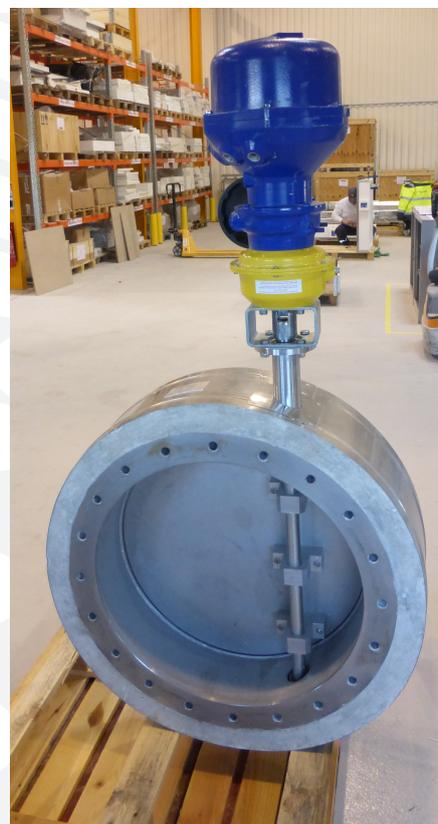
Clapet cylindrique à enveloppe étanche pour confinement. La famille des clapets coupe-feu NuFDA-1XX sont particulièrement performants en termes d'opérabilité et manœuvrabilité, tout en garantissant des requis coupe-feu et d'étanchéité très élevés.
